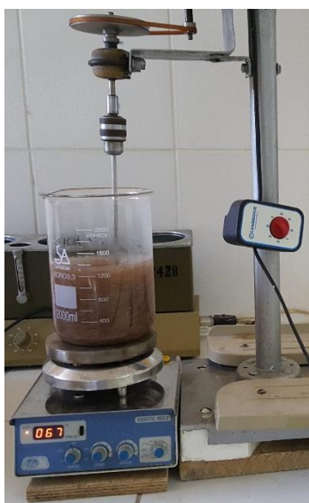
Figura 1-12: Extracción por maceración dinámica
