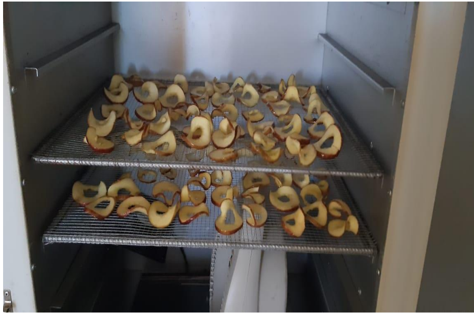
Figura 3-15. Secado en secador de bandejas
