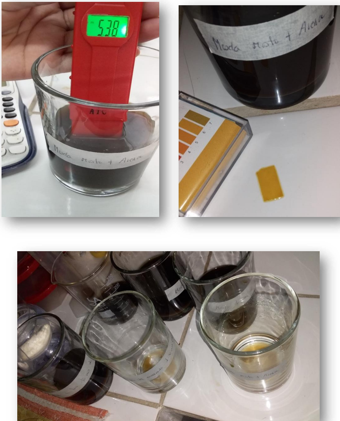
Fotografía IV-23. Medición del pH durante la elaboración de la cerveza
