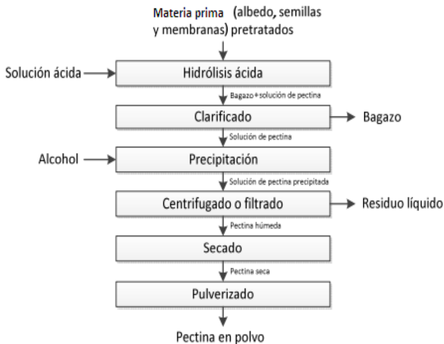
Figura 1-13 Diagrama de hidrólisis ácida convencional
