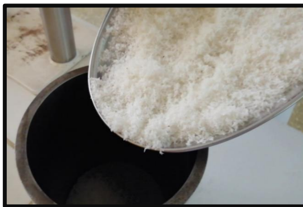
Vertido de la muestra molida, tamizada, seca al interior del cilindro para proceder al prensado de la misma.
