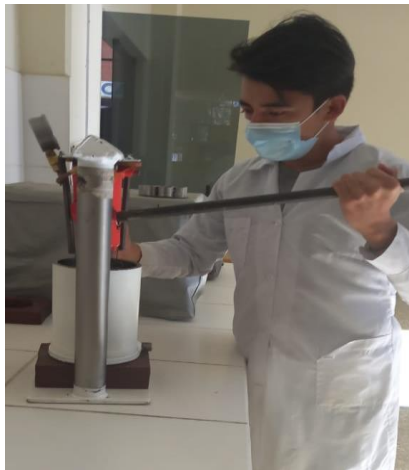
Figura 2-15 Prensado de la materia prima
