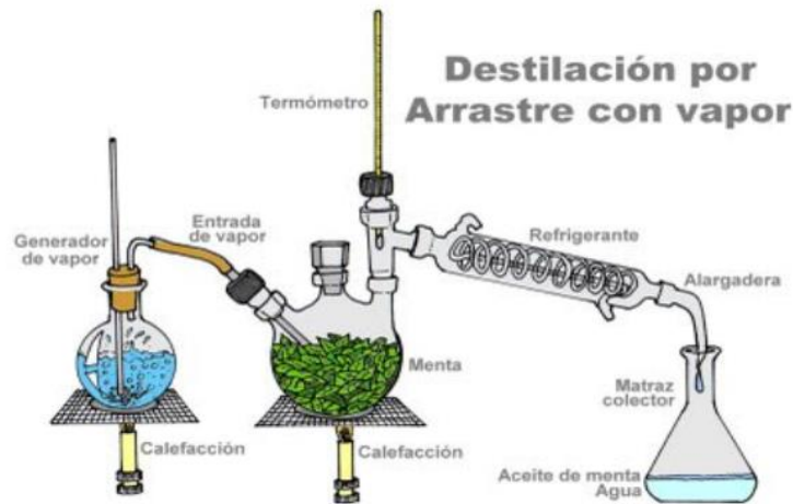
Figura 1-3 Equipo de laboratorio para destilación por arrastre de vapor.
