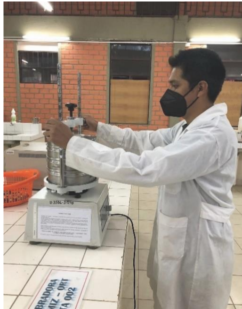
Figura 2-13 Tamizado de partículas de cáscara de pomelo rosado.
