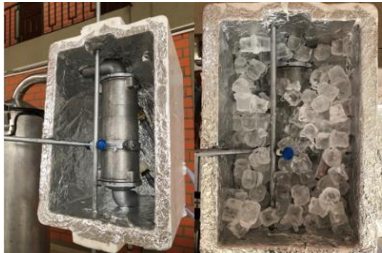
Figura 2-22 Modificación en el intercambiador de calor.
