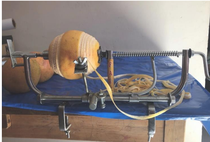
Figura 2-11 Separación del epicarpio.
