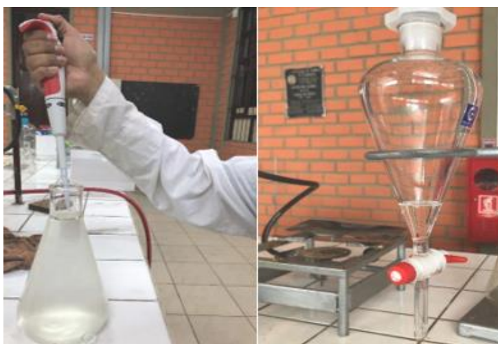
Figura 2-25 Trasvasado y separación de la mezcla.
