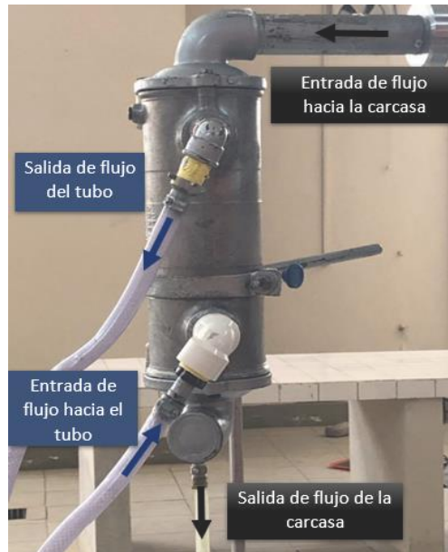
Figura 2-21 Intercambiador de calor.
