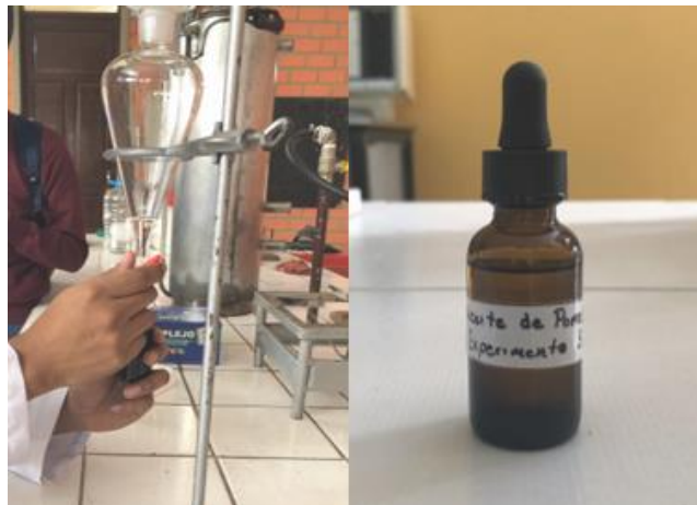
Figura 2-26 Envasado del aceite esencial.
