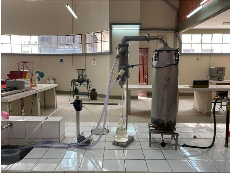
**Foto F – 5** Proceso de Destilación con Arrastre de Vapor
