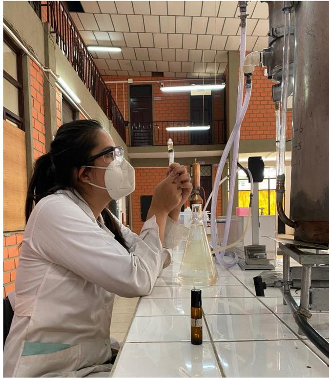
**Foto F – 7** Separación del agua destilada y el aceite esencial obtenido
