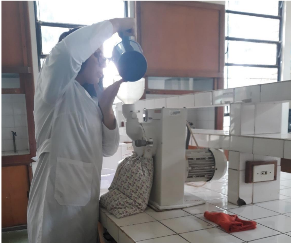
Fig. 3 - 18 Molienda de Semillas de Amaranto en Molino de Martillos
