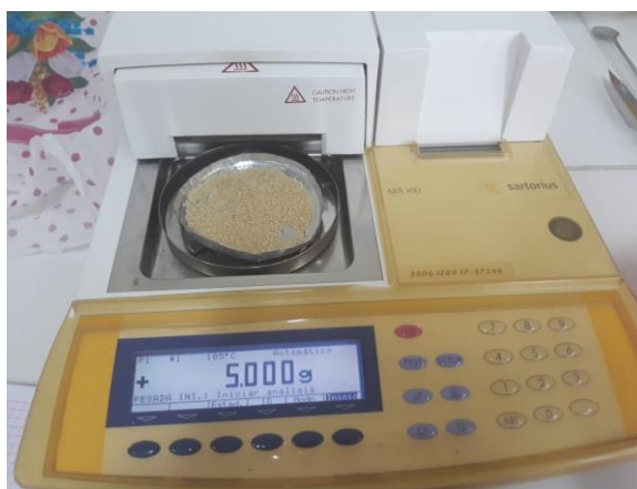
Fig. 3 - 3 Secador infrarrojo SARTORIUS MA 100.
