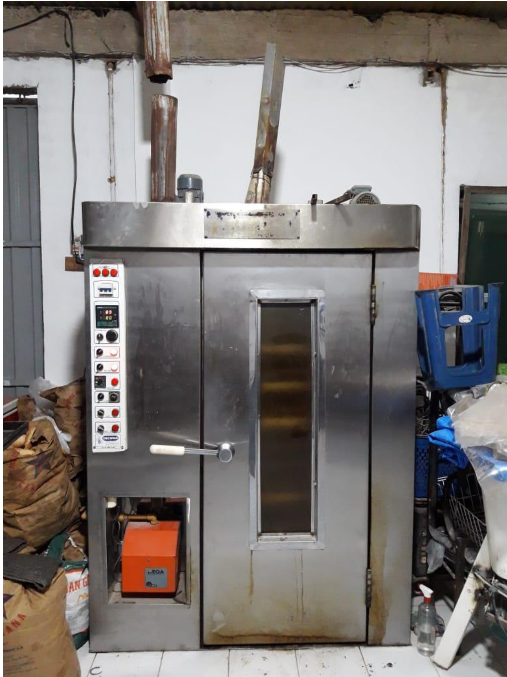
Figura 2-11 Horno rotativo FUTURO – Modelo 70 x 45/15 Full
