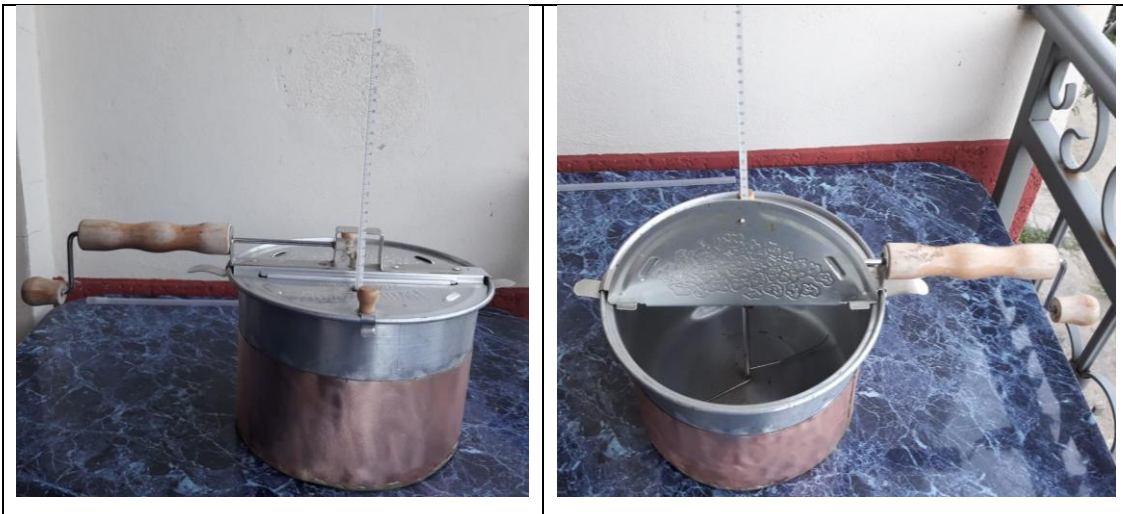
Figura 3-5 Tostador de granos acondicionado
