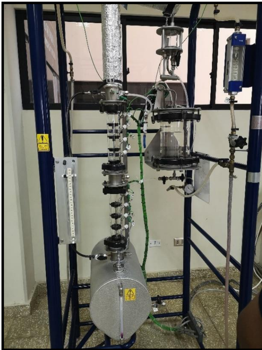
Figura 3-17 Columna de rectificación
