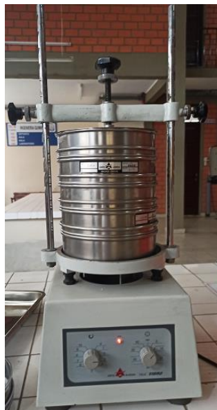
Ilustración III-7 Proceso de tamizado de la harina de tarwi
