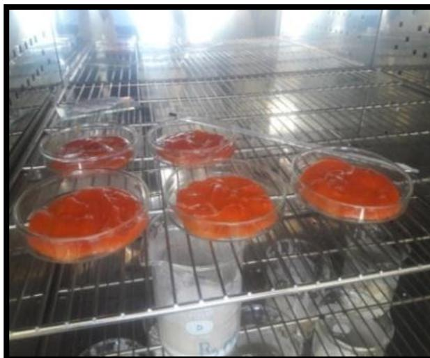
**Fotografía N° 3-12: Secado de bioplástico**
