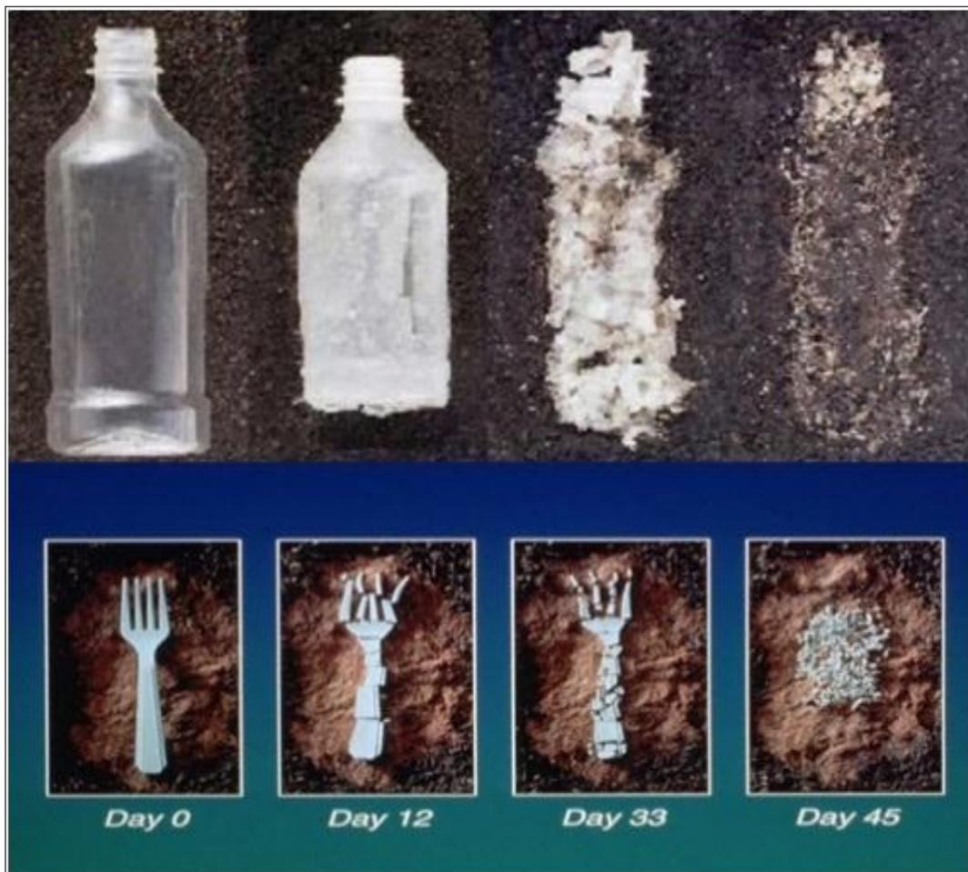
**Figura N° 2-13: Proceso de biodegradación de una botella y un tenedor**
