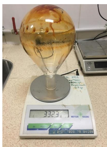
Se pesa el balón IKA2, y se observa que la masa es de 2,3 g de oleoresina.
