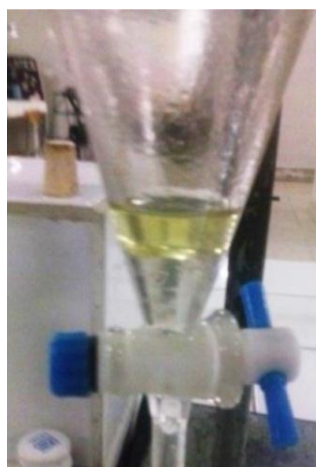
Foto II-8. Separación del aceite esencial en una ampolla de separación.
