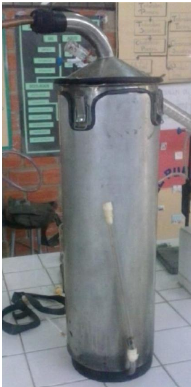
Foto II-6. Equipo de destilación por arrastre con vapor de agua.
