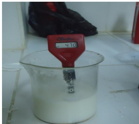
Fuente: Elaboración propia Figura 3-8. Ajuste del pH
