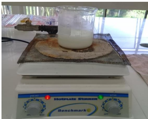
Figura 3-9. Proceso de hidrólisis en el Agitador magnético
