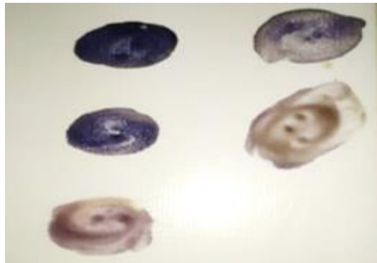
Figura II-17 Prueba del yodo a medida que avanza la hidrólisis enzimática
