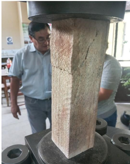
Se elaboró 15 probetas ,5 probetas por árbol con medidas de 5\*5\*20 cm, El ensayo se realizó de acuerdo a la norma COPANT 464 solo en estado seco al aire, se colocó la probeta en la maquina universal de ensayo, descansando sobre la base fija de la prensa y en la parte superior se utilizó un plato móvil para compensar posibles fallas de escuadría en la sección transversal.
