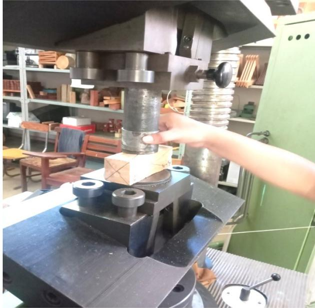
Se elaboró 15 probetas 5 probetas por árbol, los ensayos se realizaron de acuerdo a lo estipulado a la norma COPANT 465 solo en estado seco al aire, según la norma la resistencia que pone la madera a la penetración de una semiesfera metálica de 11,284 mm de diámetro según Janka y que ocasiona su sección una superficie de 1cm<sup>2</sup>.
