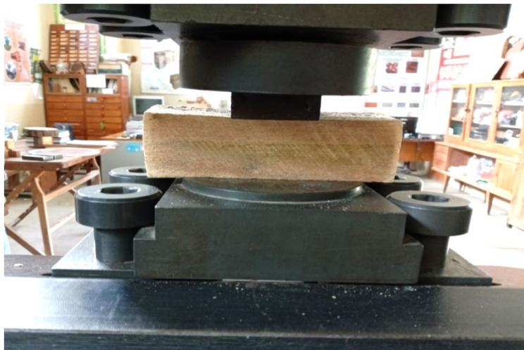
Se elaboraron 15 probetas 5 probetas por árbol con medidas de 5\*5\*15 cm de longitud según la norma COPANT 466.solo en estado seco al aire.
