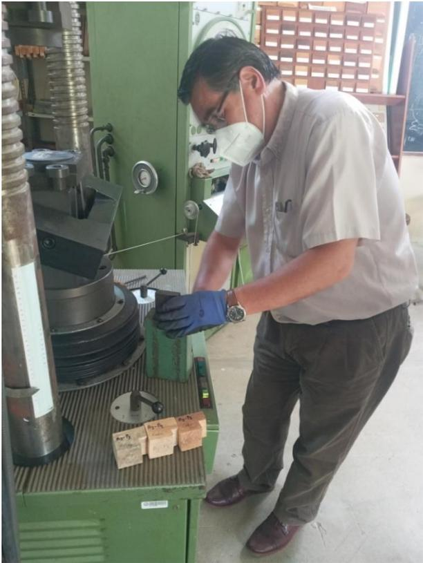
**FOTO N° 14 ENSAYO DE DUREZA DE LA MADERA.**
