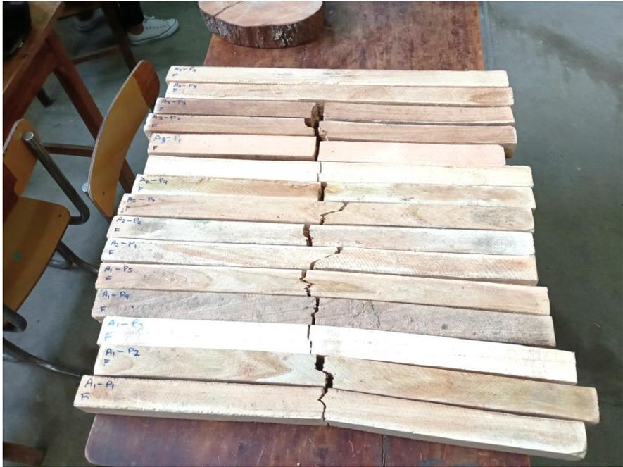
**FOTO N° 11 ENSAYO DE COMPRESIÓN PARALELA AL GRANO.**
