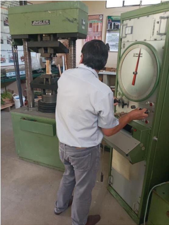
**FOTO N° 12 ENSAYO DE COMPRESIÓN PERPENDICULAR AL GRANO.**
