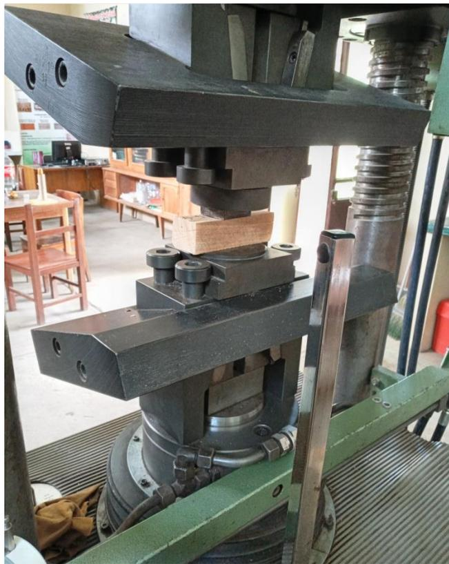
**FOTO N° 13 ENSAYO DE CIZALLAMIENTO.**
