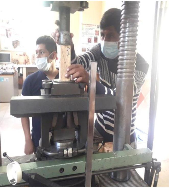
FOTO N° 15 ENSAYO DE EXTRACCIÓN DE CLAVOS.
