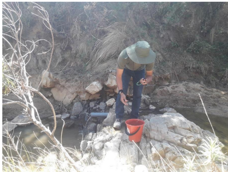
Foto 2. Medición del caudal por el método volumétrico
