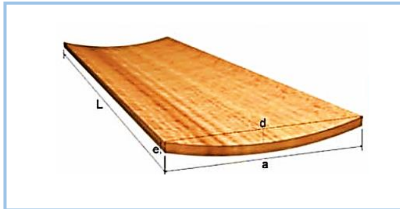
FIGURA N° 1: ABARQUILLADO O ACANALADURA
