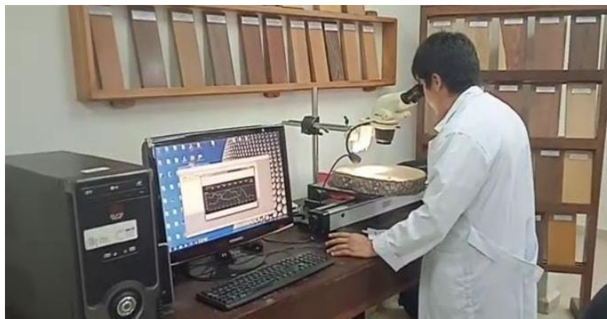
FIGURA 9: Medición de los Anillos mediante el uso del Lintab
