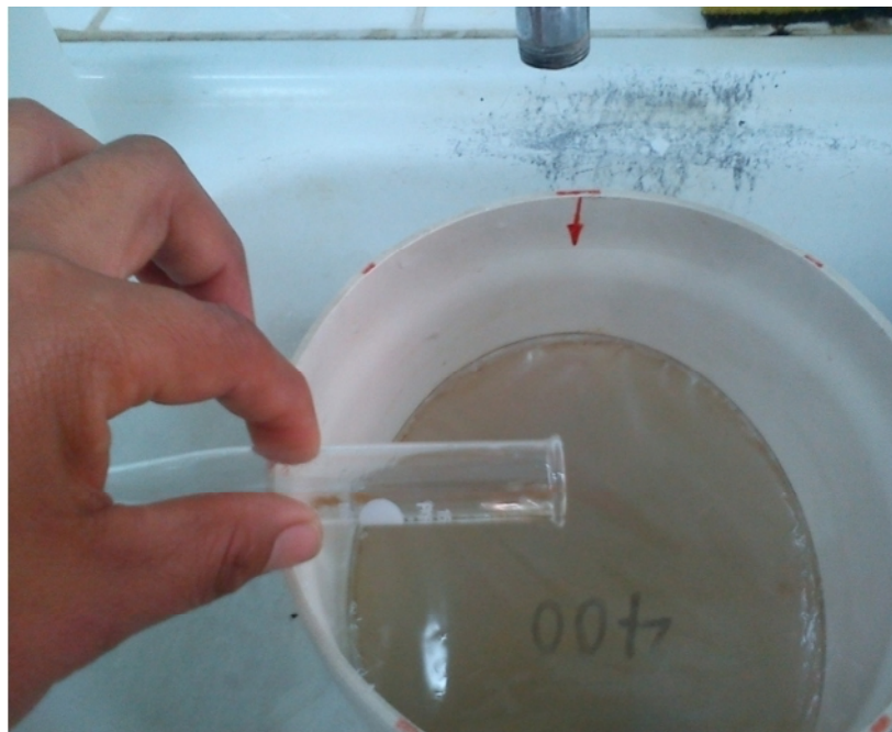
Figura N° 3: Recuperación y lavado de sobrenadante con nematodos en Tamíz N° 400. 2011
