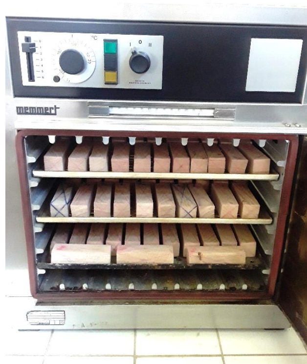
Método de secado en estufa en el laboratorio de la madera de la Universidad Autónoma Juan Misael Saracho
