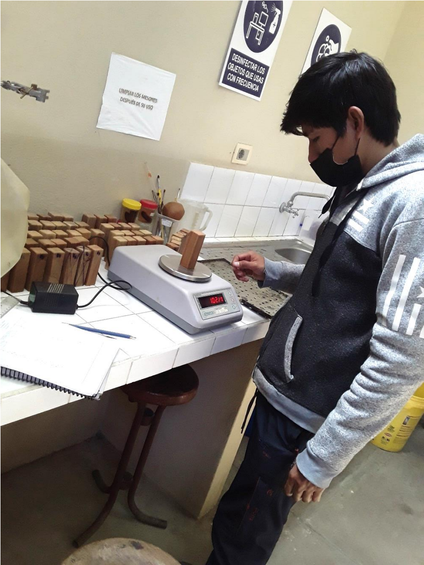
Pesado de las probetas del toborochi
