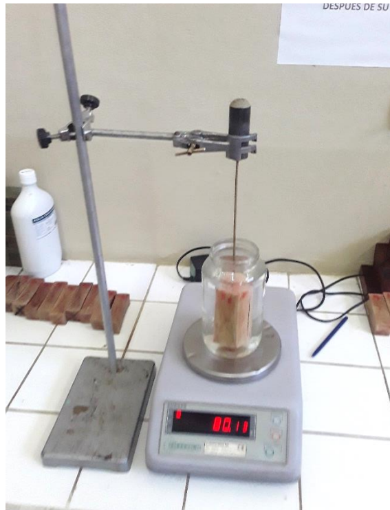
Determinación del volumen por el método de inmersión en agua destilada.
