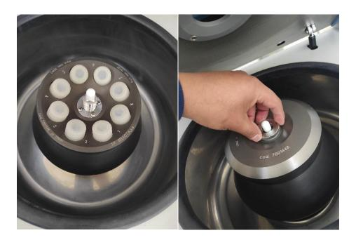
Posterior a un tiempo de 10 minutos y con una velocidad de 8000 rpm se procede a retirar las muestras y se observa la separación de los sólidos suspendidos, tomando una muestra de la fase líquida con gotero esta es usada para lecturar los grados Brix en cualquier equipo:
