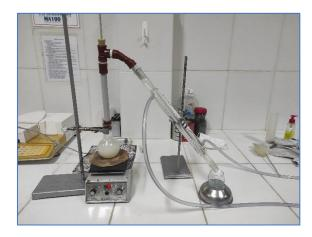
Al cabo de un periodo de tiempo se tiene las primeras gotas del destilado, este proceso toma un tiempo de 45 minutos a 1 hora aproximadamente. Posterior a esta destilación, se trasvasa el destilado a una probeta y se enrasa a 100 ml con agua destilada y se
