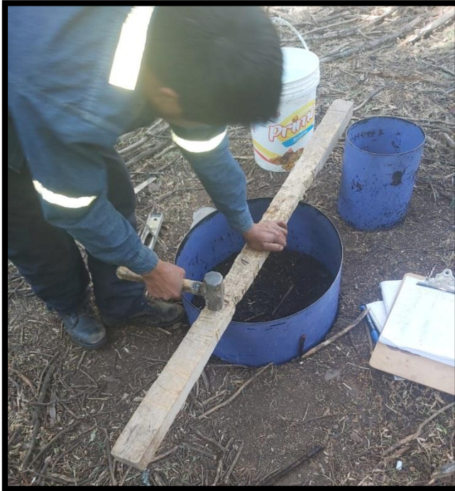
Fotografía N° 14 Instalación de los cilindros doble anillo para el estudio
