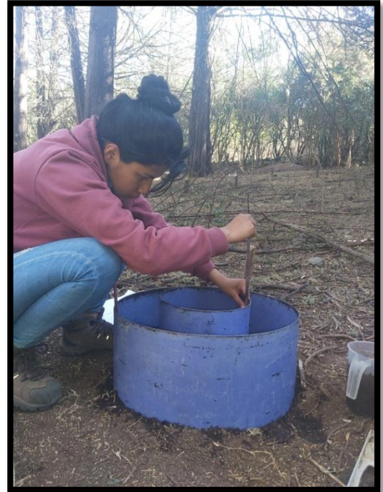
Fotografía N° 15 Medición de la altura del cilindro
