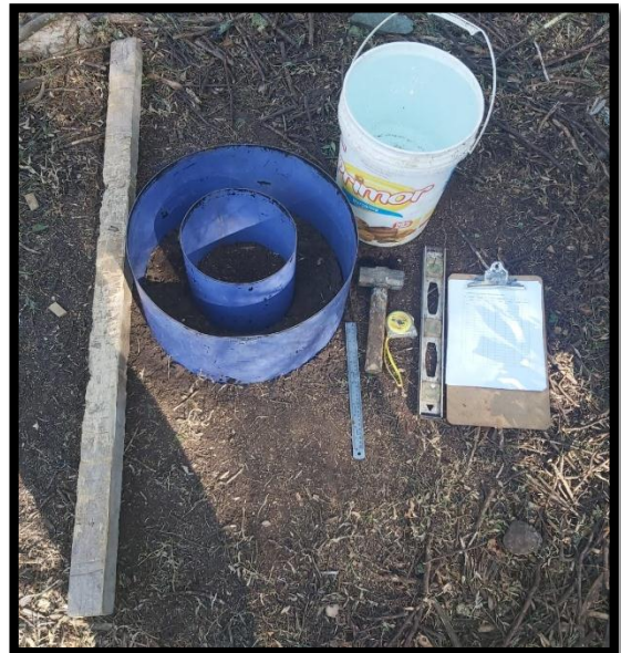
Fotografía N° 13 Herramientas utilizada en la evaluación de infiltración
