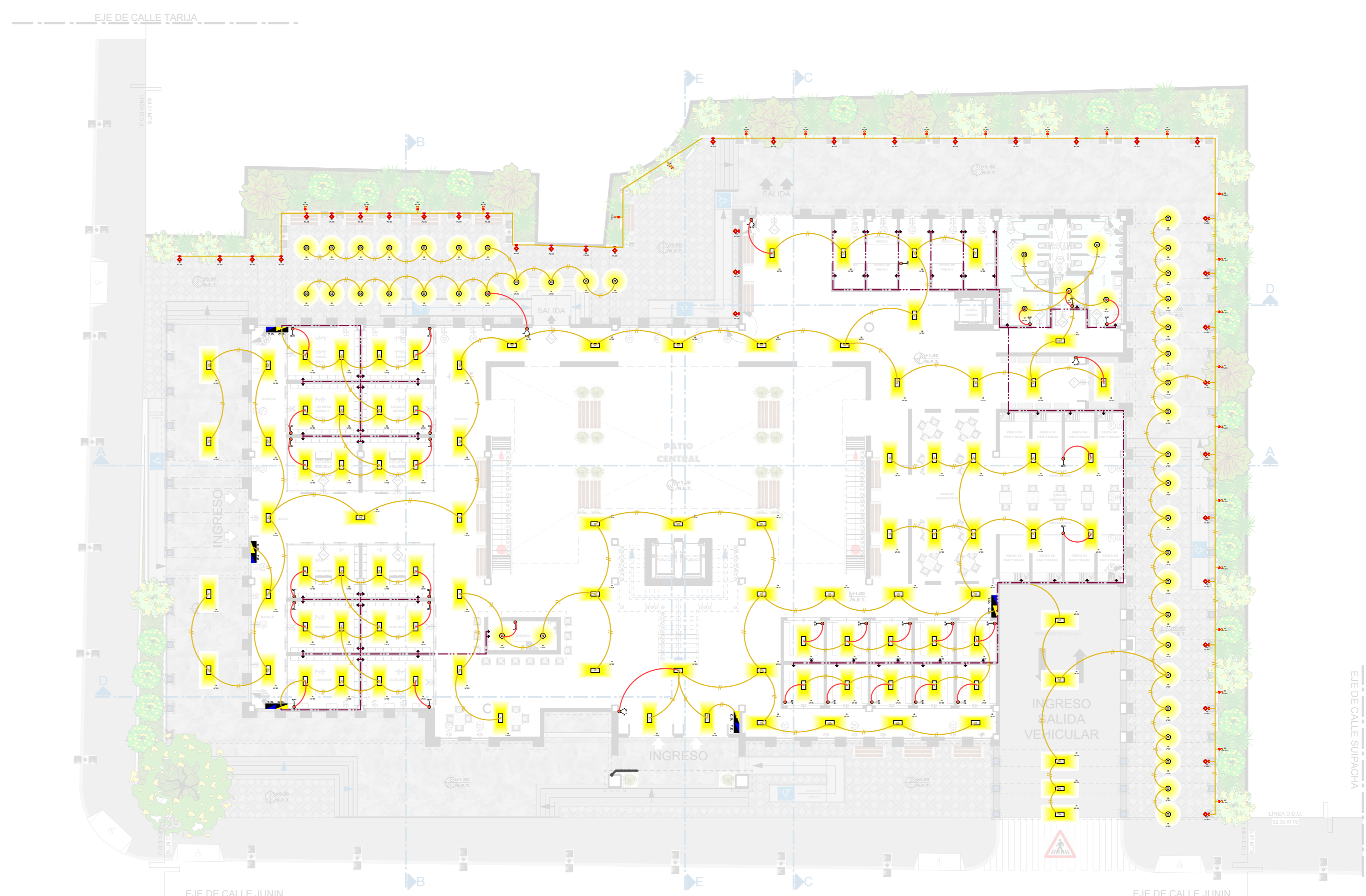
PLANO DE INSTALACION ELECTRICA PLANTA BAJA Scale: 1:200
