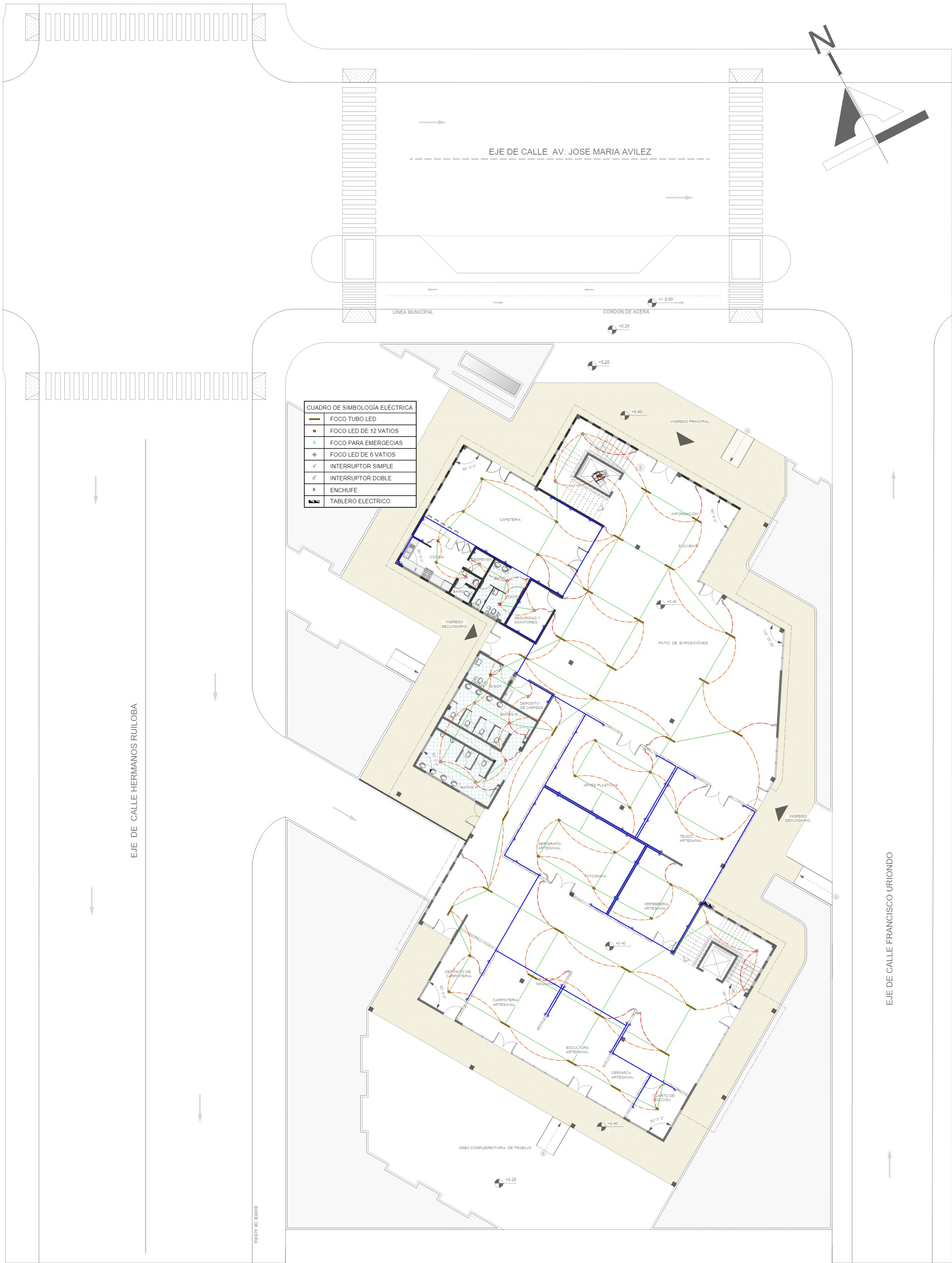
PLANO DE INSTALACIONES ELÉCTRICAS DE PLANTA BAJA ESC. 1 : 100
