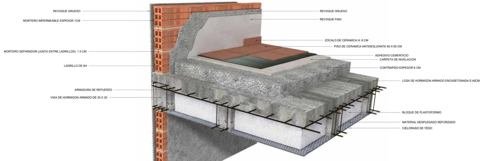
**LOSA ENCASSETONADA o NERVADA:** Nos permiten luces mayores que las losas macizas. Trabajan igual que una losa maciza, a flexión en las dos direcciones, soportando las cargas los nervios resistentes que forman la retícula de la placa. El aligeramiento de la placa se consigue colocando casetones en las zonas de menores esfuerzos cortantes, dejando entre ellos los nervios resistentes en las dos direcciones.
