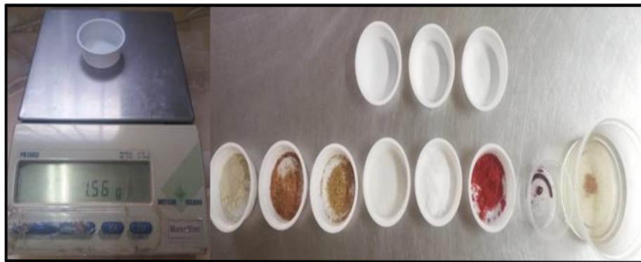
Figura 3.15: Proceso de pesado de aditivos e insumos.
