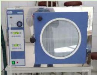
Marca SELECTA, modelo 4001489, capacidad 47 L, volumen útil 70 %, vacío máximo  $10^{-2}$  mmHg, consumo 2200 W, peso 73 kg, rango de temperatura 35 °C hasta 200 °C, estabilidad  $\pm 1$  °C, homogeneidad  $\pm 2$  °C.
