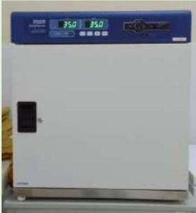
Marca ESCO, modelo IFA-110-8, volumen interior 110 L, interior (alto, ancho, fondo) 49,0/56,0/50,0 cm, exterior (alto, ancho, fondo) 78.5/71,0/58,7 cm, potencia eléctrica 745.7 W, temperatura máxima 100 °C.
