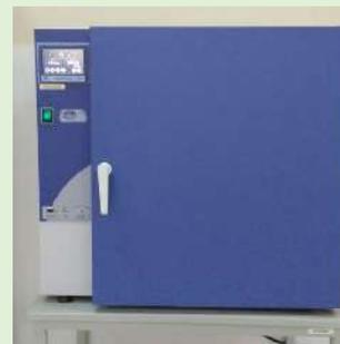
Marca SELECTA, modelo 2005165, volumen interior 76 L, interior (alto, ancho, fondo) 58,0/38,0/40,0 cm, exterior (alto, ancho, fondo) 70,0/75,0/65,0 cm, potencia eléctrica 1600 W, rango de T desde  $T_{amb} + 5$  °C hasta 250 °C.
