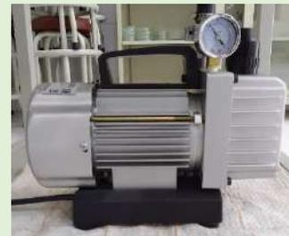
Modelo XZ-1B bomba aspiradora, bomba comer 1L/S, límite de vacío 50 Pa, velocidad 1.400 r/min, energía 120 W, voltaje 220 V/50 Hz
