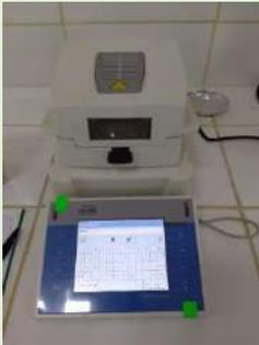
Marca RADWAG, modelo PM 60.3Y.WH, capacidad de peso máximo 60 g, temperatura máxima 250 °C
