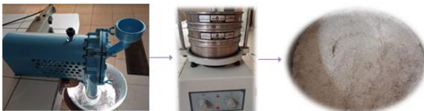
Fuente: LOU Figura 3.11: Molienda y tamizado de harina de maíz morado
