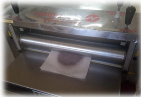
Figura 3.17: Laminado de la masa
