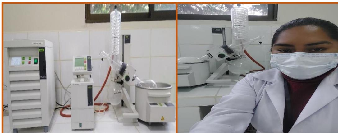
Destilación al vacío con el equipo Rota vapor
