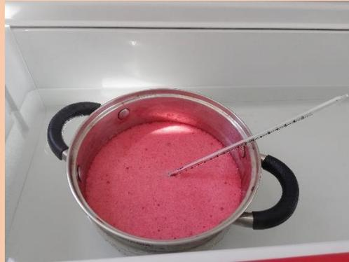
La pasteurización se llevó a cabo en un termostato eléctrico en baño María.
