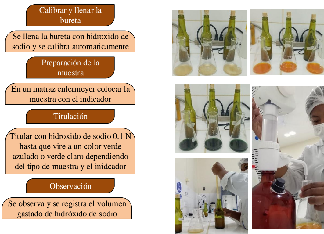
Figura G.6: Procedimiento para determinar la acidez
