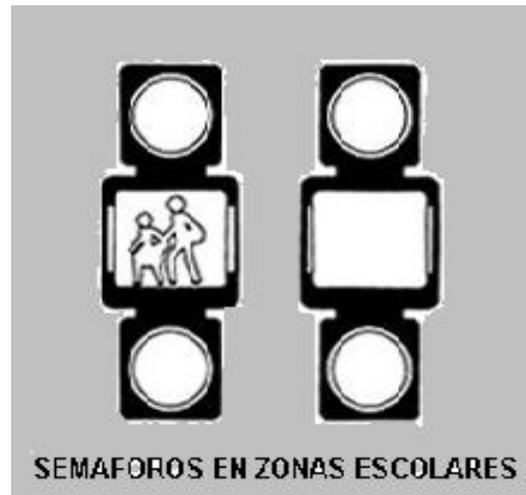
Figura. 3.6 Semáforo para peatones con la indicación ALTO y PASE
