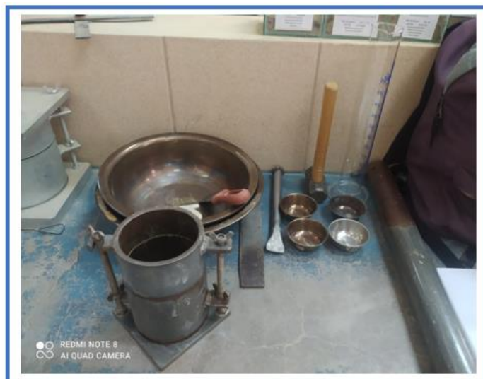
Figura 3.14 Materiales para el ensayo de compactación
