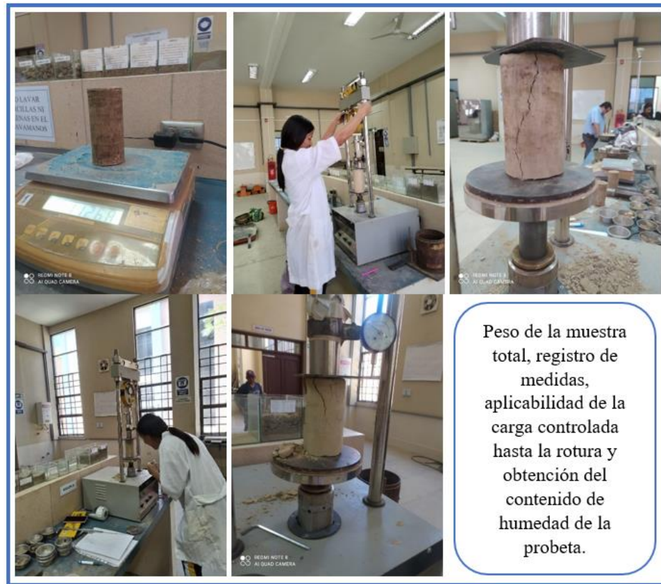
Figura 3.21 Práctica de compresión no confinada
