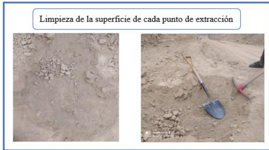
Figura 3.2 Limpieza del área de extracción de muestra
