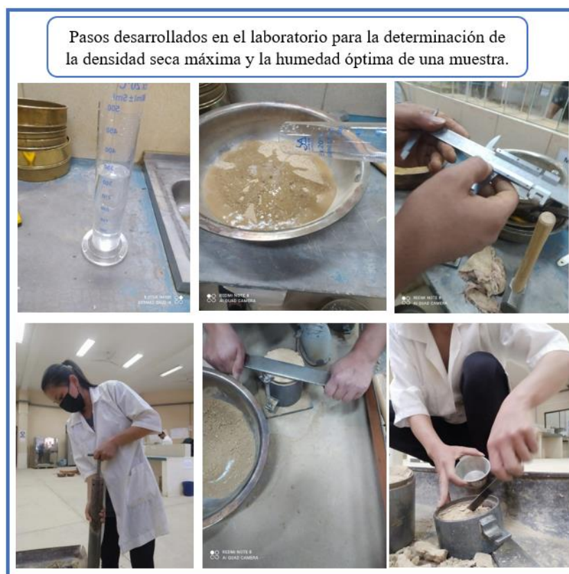
Figura 3.15 Práctica de compactación
