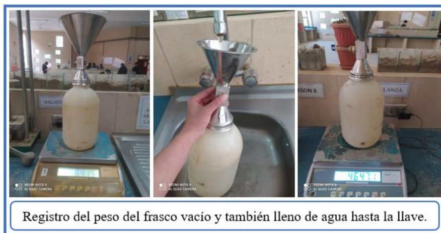
Figura 3.18 Práctica de calibración del frasco
