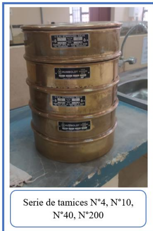
Figura 3.6 Materiales para el ensayo de granulometría
