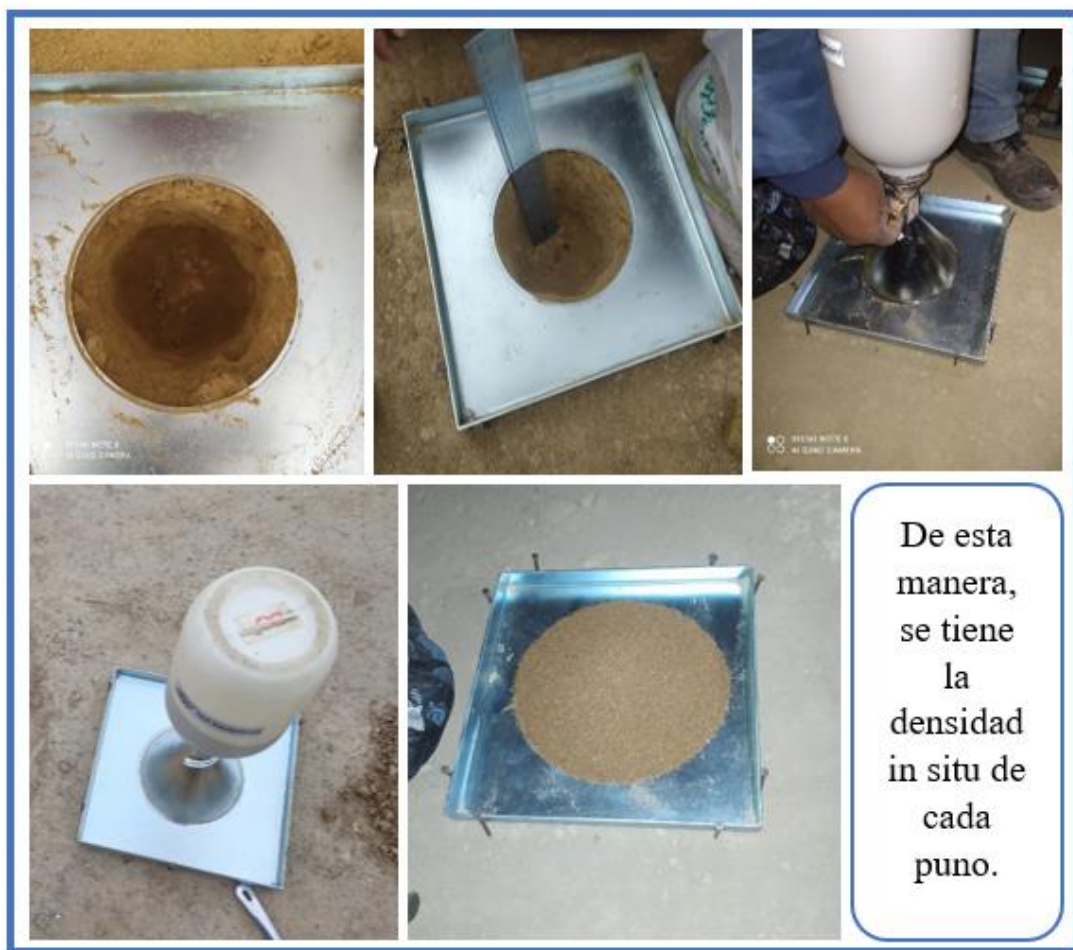
Figura 3.20 Práctica en campo del cono de arena
