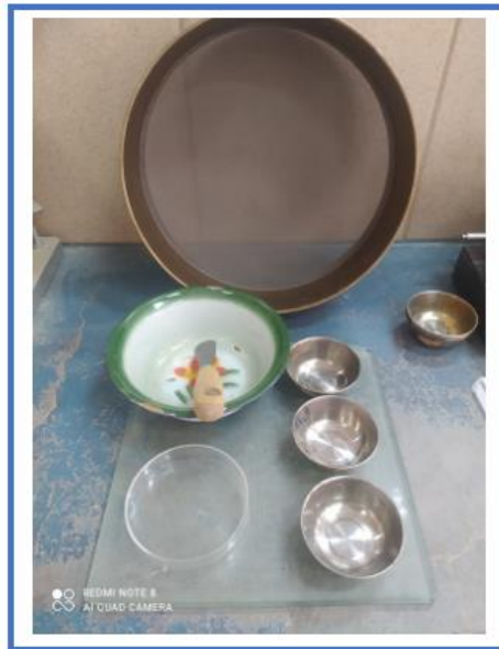
Figura 3.12 Materiales para el ensayo de límite plástico
