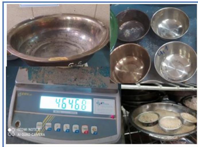
Figura 3.4 Materiales para el ensayo de contenido de humedad
