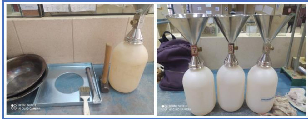
Figura 3.17 Materiales para el ensayo de densidad In Situ
