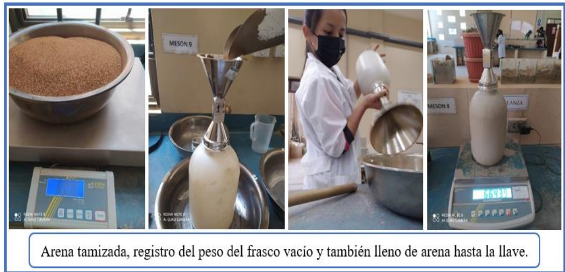
Figura 3.19 Práctica de la calibración de arena
