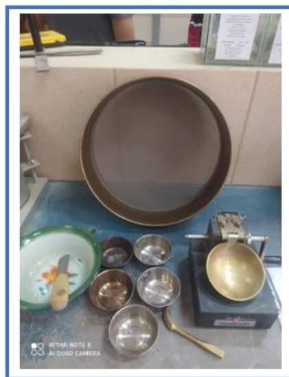
Figura 3.9 Materiales para el ensayo de límite líquido
