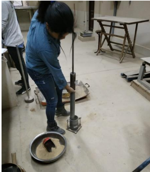
Figura 31 Compactación de la muestra barrio San Mateo
