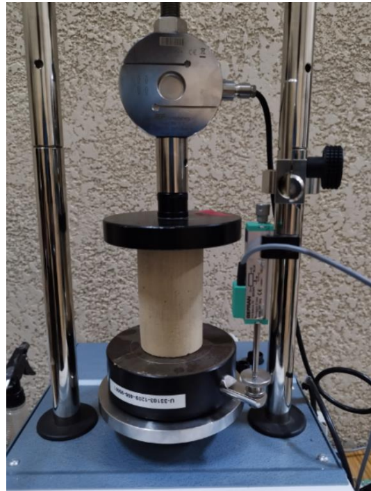
Máquina de compresión no confinada.
