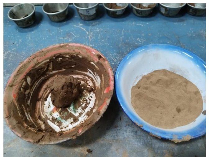
Determinación del límite líquido.
