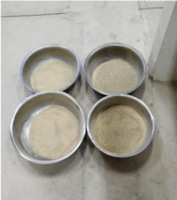
Muestra tamizada antes de la compactación.
