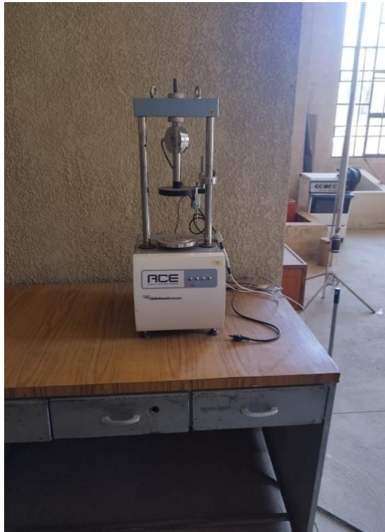
Máquina de compresión no confinada.
