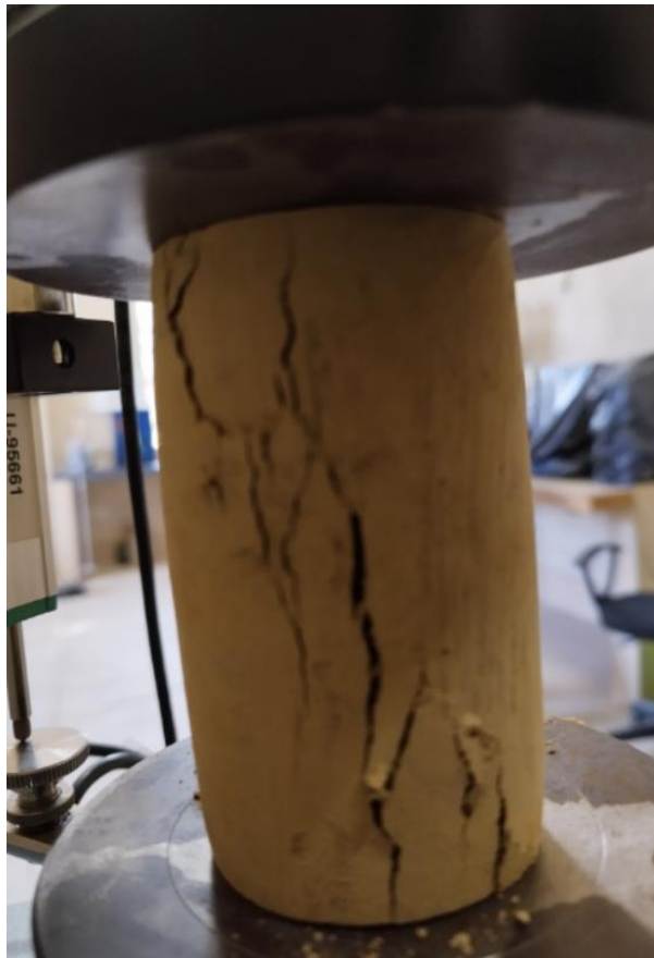
Rotura de la probeta.
