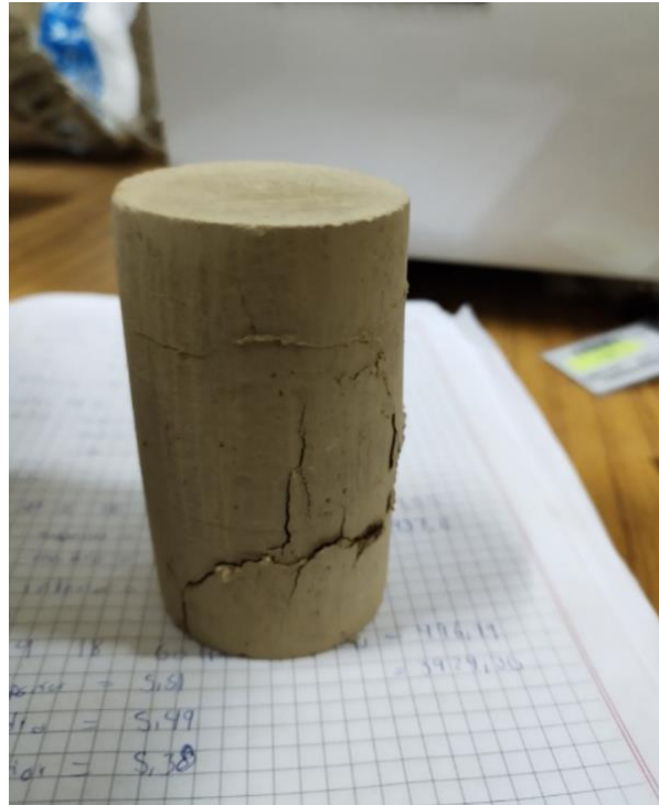
Rotura de la probeta.
