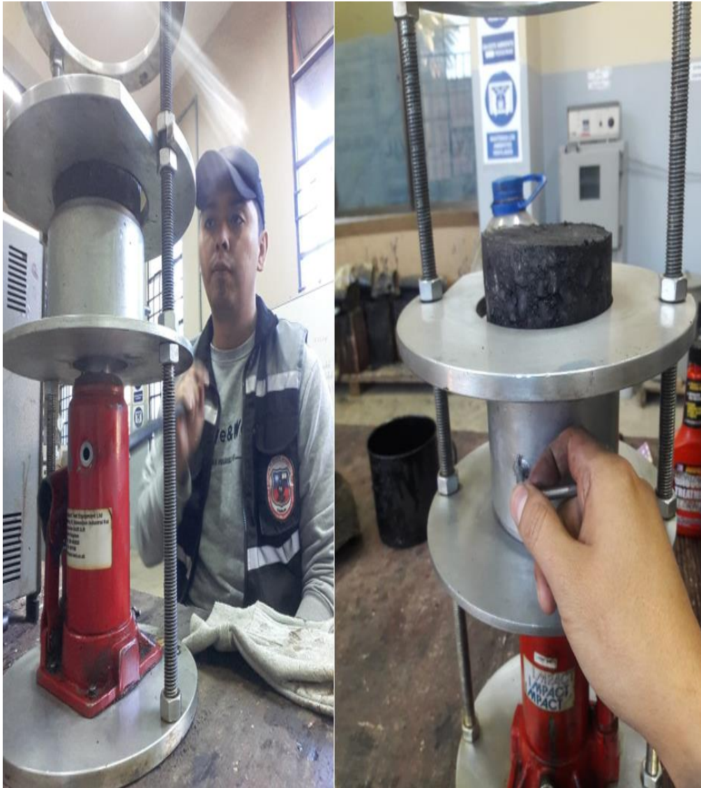
Figura 3.54 Extracción de la briqueta
