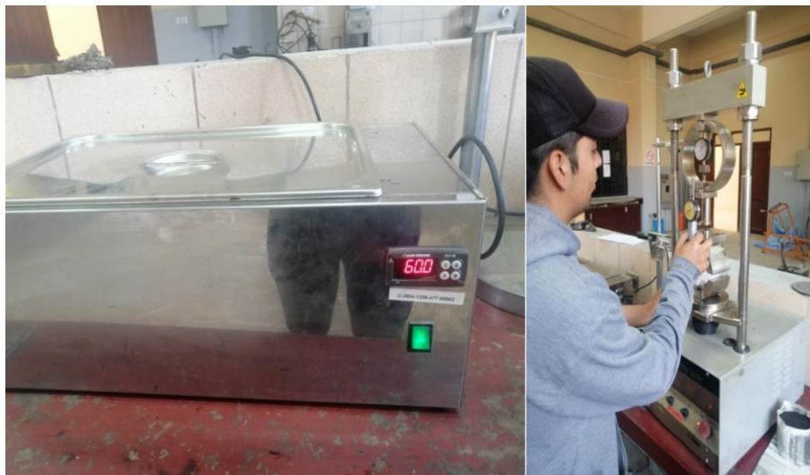
Figura 3.32 Determinación de estabilidad y fluencia de las briquetas
