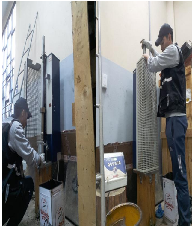
Figura 3.54 Proceso de compactación de la briqueta
