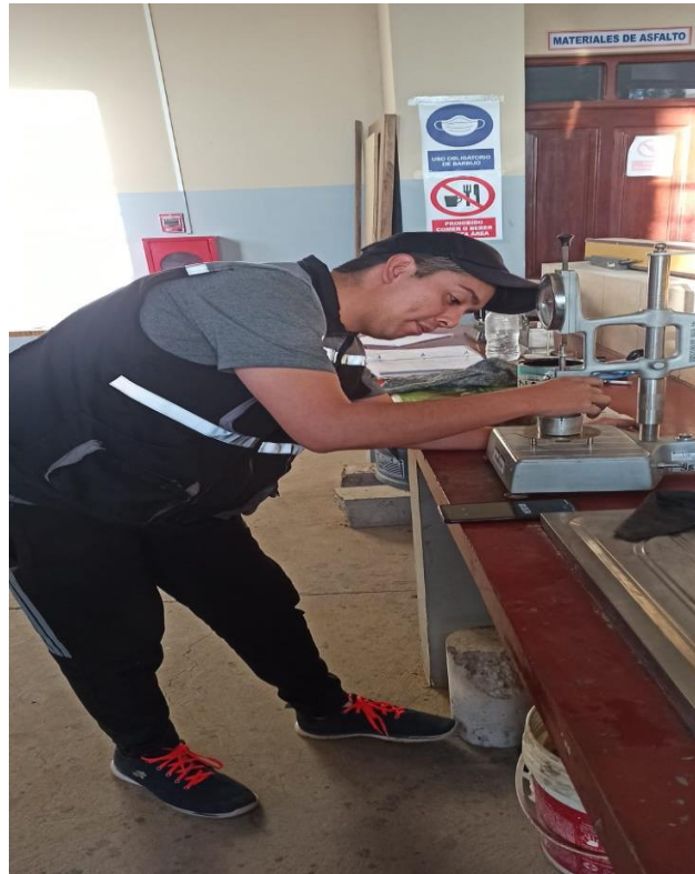
Figura 3.48 Realización del ensayo de penetración del cemento asfáltico
