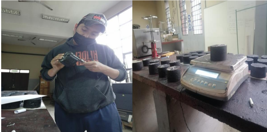
Figura 3.30 Medición de alturas y determinación de peso seco de las briquetas
