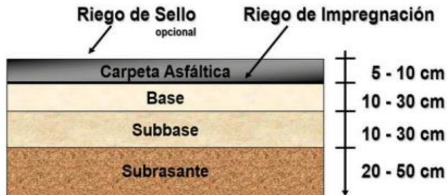
Figura 2.1 Paquete estructural pavimento flexible
