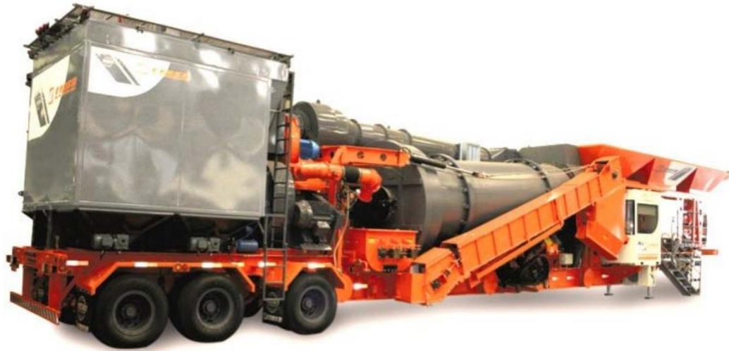
Figura 2.22 Planta asfáltica continua modular más 2 termo tanque marca ciber
