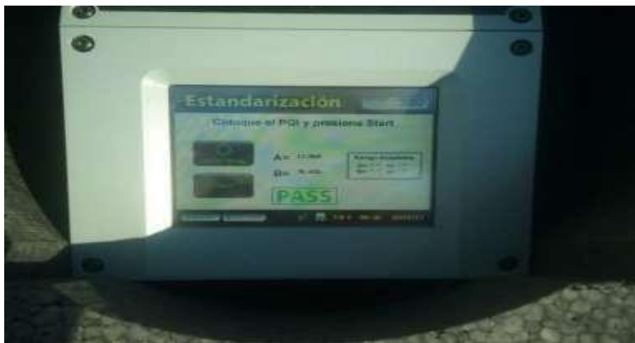
Figura 2.20 Calibración mediante la placa de verificación
