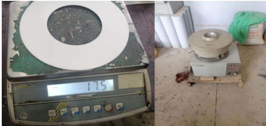
Figura 3.34 Papel filtro y centrifugo armado
