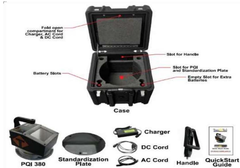
Figura 2.5 Partes del densímetro PQI 380
