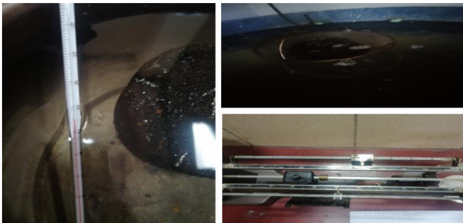
Figura 3.31 Peso superficialmente seco y peso específico sumergido
