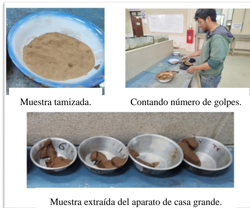
Figura 3.6 Ensayo Límite líquido
