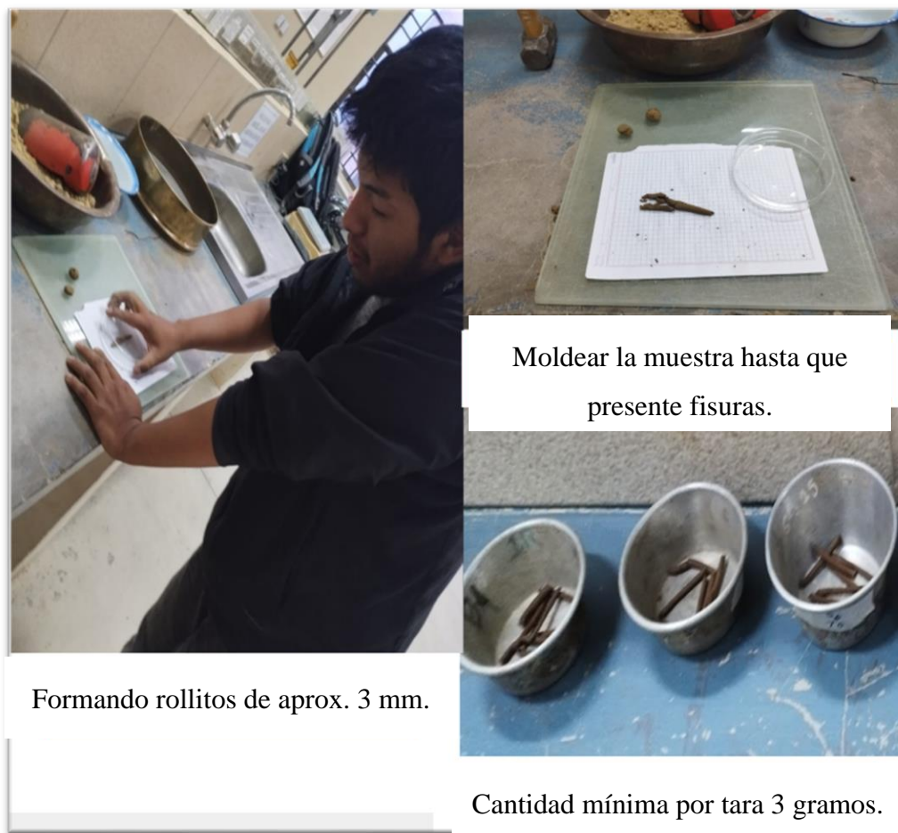
Figura 3.7 Ensayo de Límite plástico
