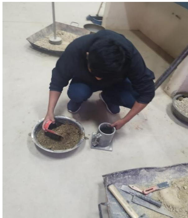
Rellenado de cinco capas.
