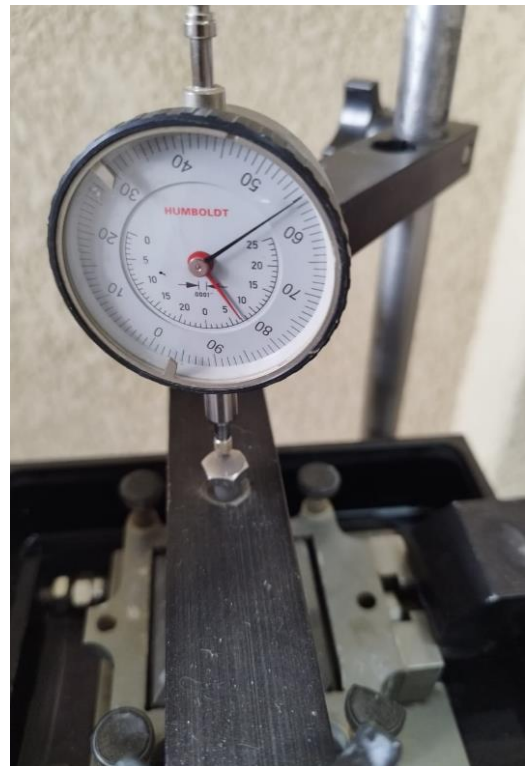
Muestra tallada y calibración de manómetros.
