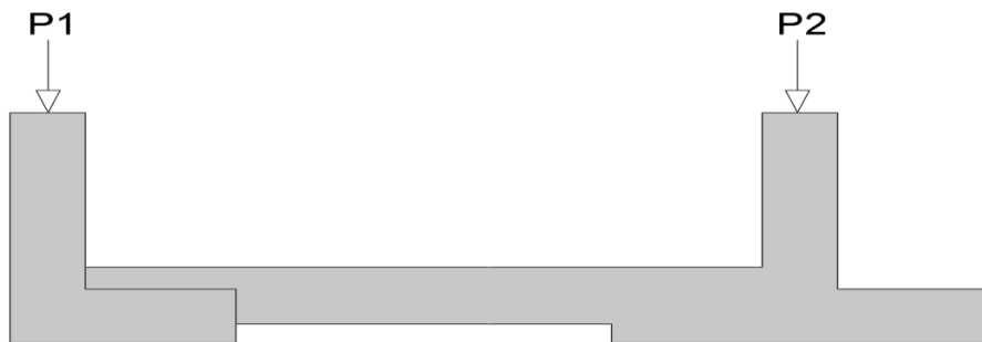
Figura 17. Zapata medianera con viga centradora
