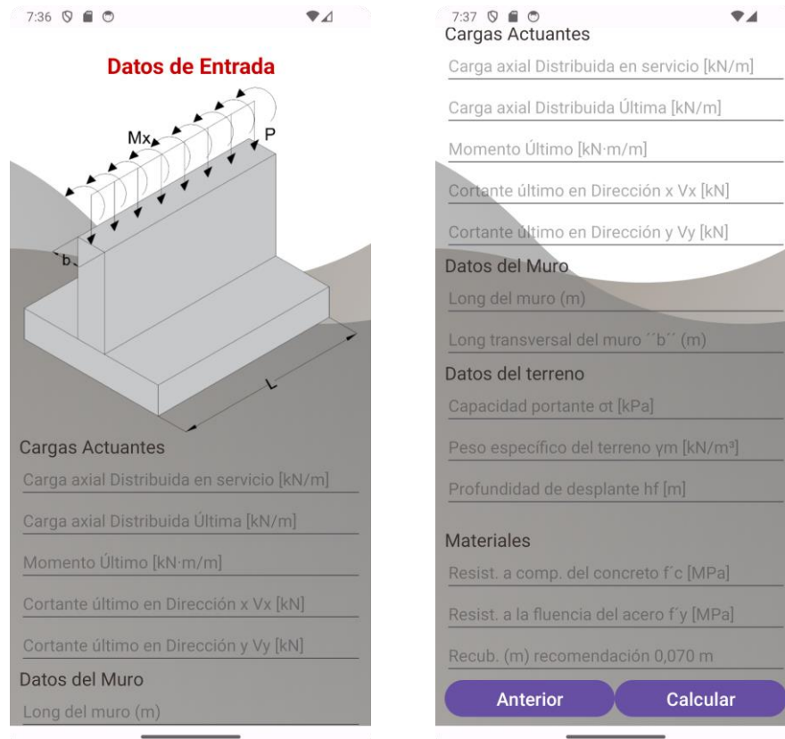
Figura 48: Interfaz Zapatas Corridas Bajo Muro de Carga
