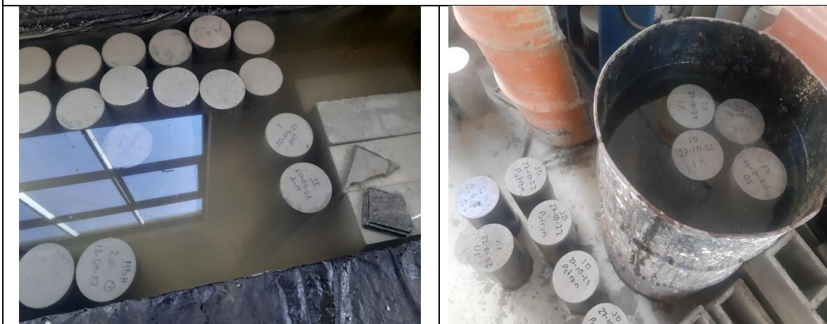
Curado del hormigón
