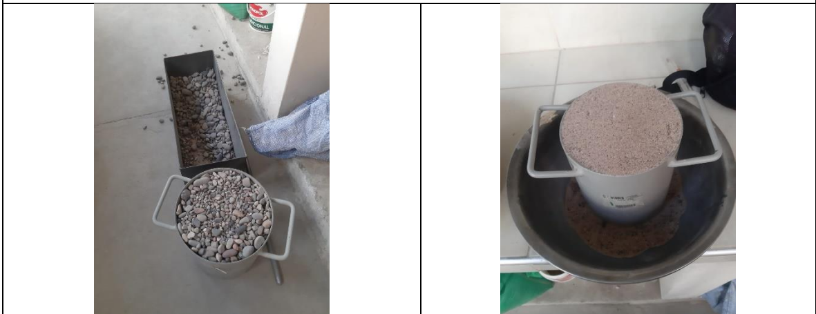
Ensayo para determinar peso unitario suelto y compactado
