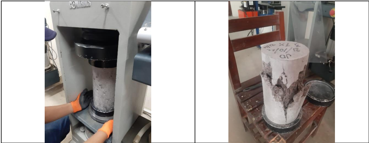
Ensayo de rotura de probetas a compresión según ASTM C39
