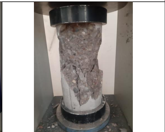
Rotura a compresión del hormigón 28 días de edad 1,5% aditivo
