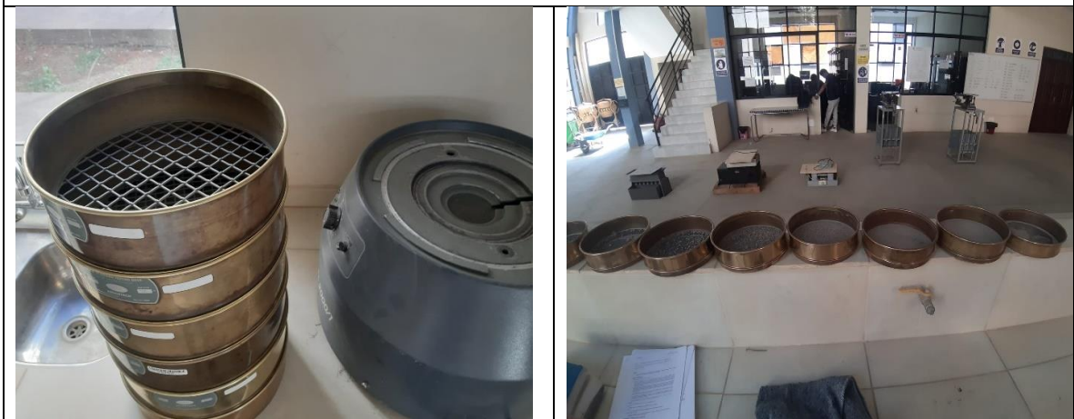
Ensayo de granulometría de la grava
