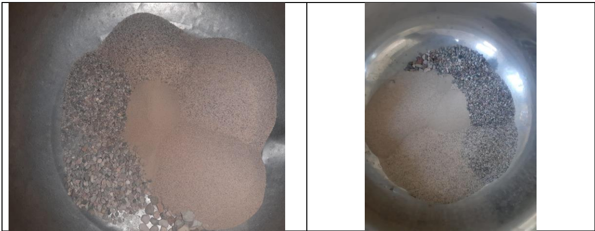
Ensayo de granulometría de la Arena
