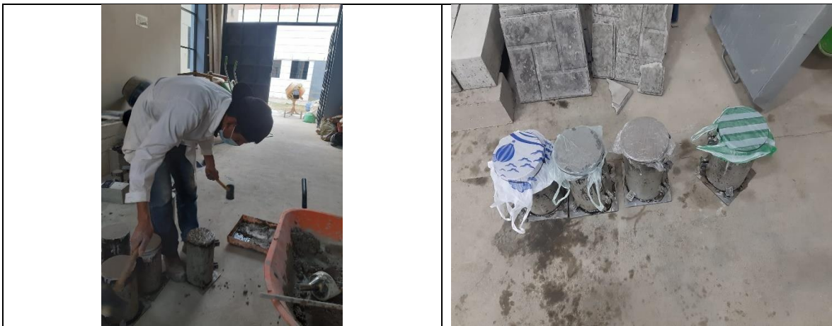
Llenado y curado de probetas según ASTM C192
