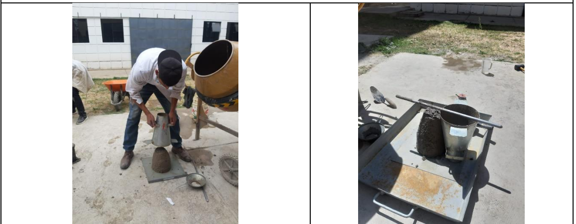
Ensayo para determinar la docilidad mediante el cono de Abrams
