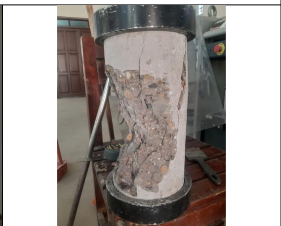
Rotura a compresión del hormigón 28 días de edad 2,0% aditivo
