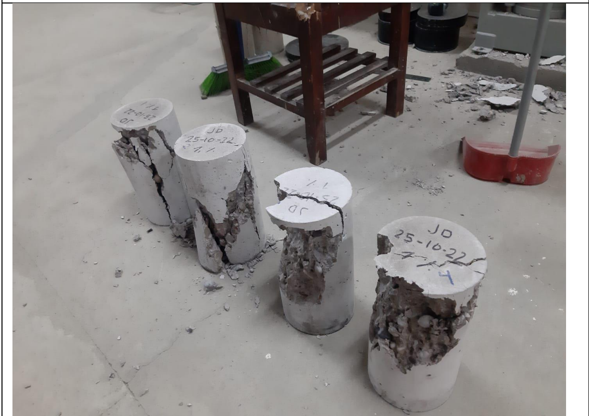
Rotura a compresión del hormigón 28 días de edad 2,0% aditivo
