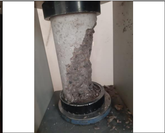
Rotura a compresión del hormigón 28 días de edad 1,0% aditivo
