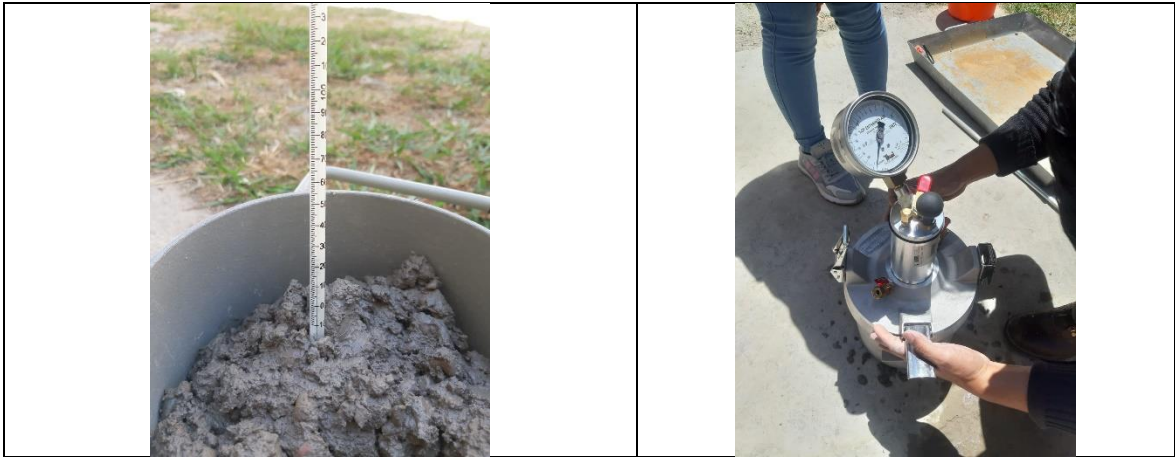
Medición de la temperatura y contenido de aire
