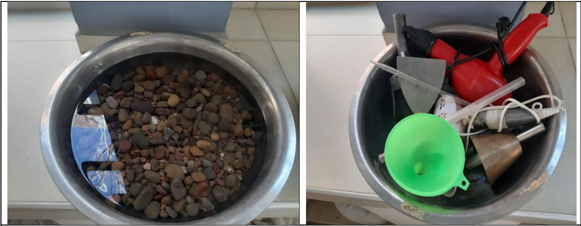
Ensayo para determinar porcentaje de absorción
