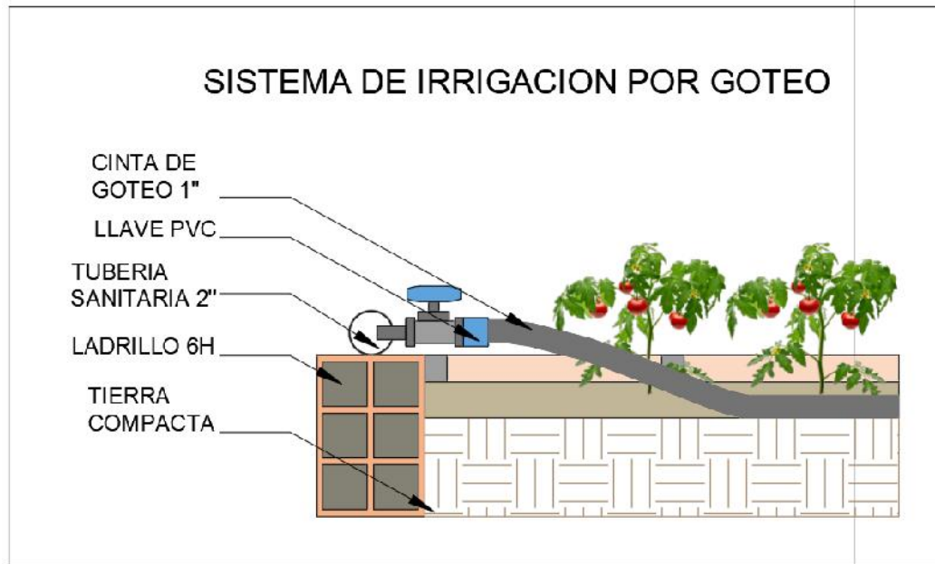
Ilustración 39: Instalación de sistema de irrigación - Elaboración Propia
