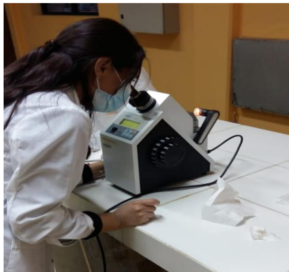
Figura IV-1. Medición de los grados Brix
