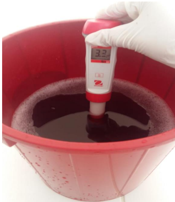
Figura IV-4. Medición del pH
