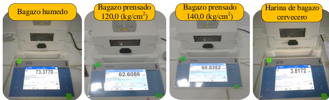
Figura G.2.1: Determinación del contenido de humedad por método termobalanza
