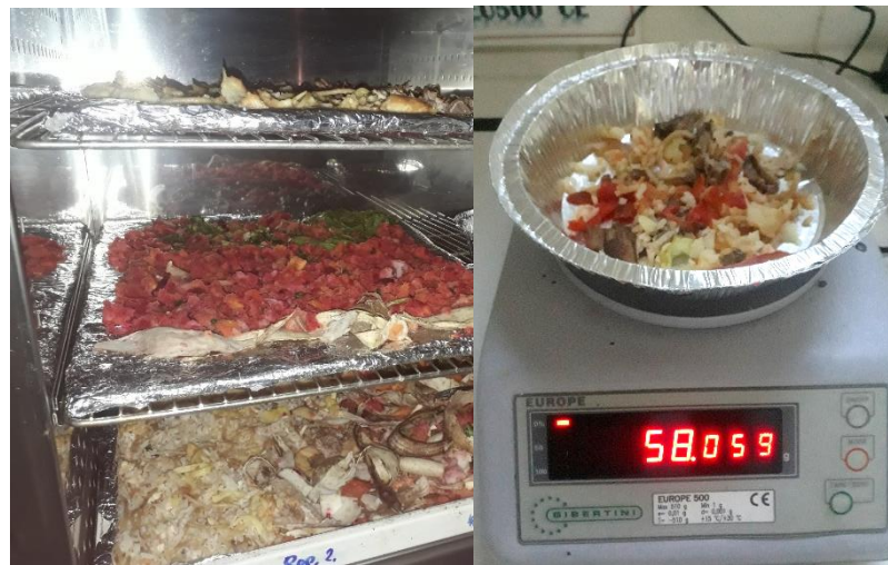
Figura 2-14 Proceso de secado de los residuos orgánicos sólidos
