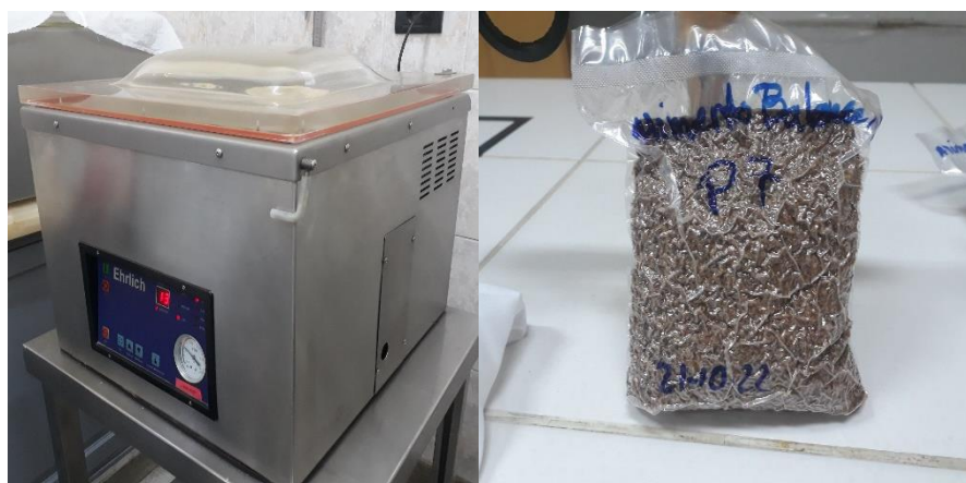
Figura 2-19 Envasado del alimento balanceado
