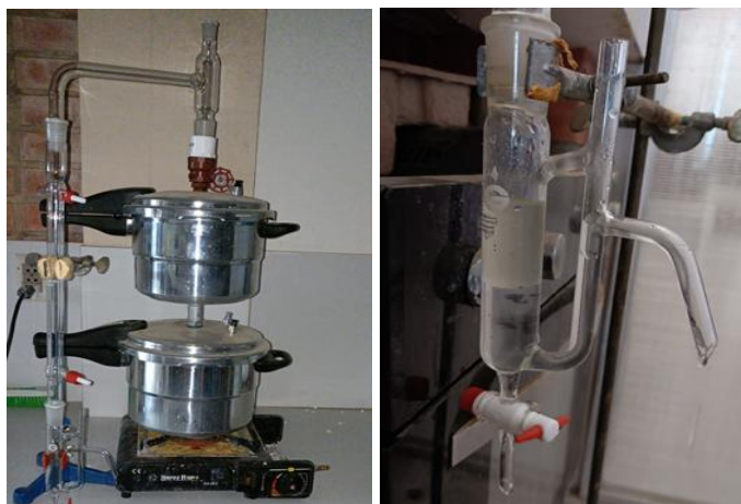
Fig. 3-2. Condensado y decantado del aceite esencial.
