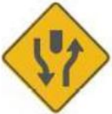
SP-62 INICIO VÍA CON SEPARADOR
