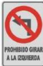
SR-6 PROHIBIDO GIRAR A LA IZQUIERDA
