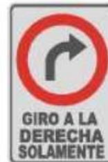
SR-7 GIRO A LA DERECHA SOLAMENTE
